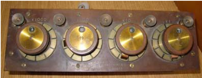
Otpornička dekada na kojoj su vidljivi svi ostali njeni podaci
