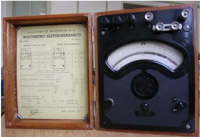
Wattmetar 75/150 V, 0,5/1 A, klase 0,2 (A.B.&CO.Milano, s jasnim datumom proizvodnje i originalnim potpisom ovlaštene osobe)
